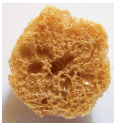
Řez kuličky SIOPORU. Průměr kuličky cca 6 mm
